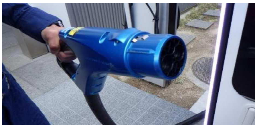
ウ コネクター（充電用ケーブルを電気自動車等に接続するためのもの）
