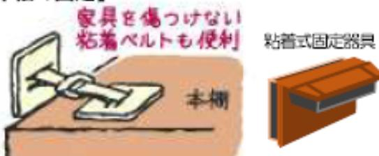
タンスと同じように、壁の中の堅い所があるところにポール式器具を取りつけます。また、壁に穴をあけないタイプの粘着式の固定器具もあります。
