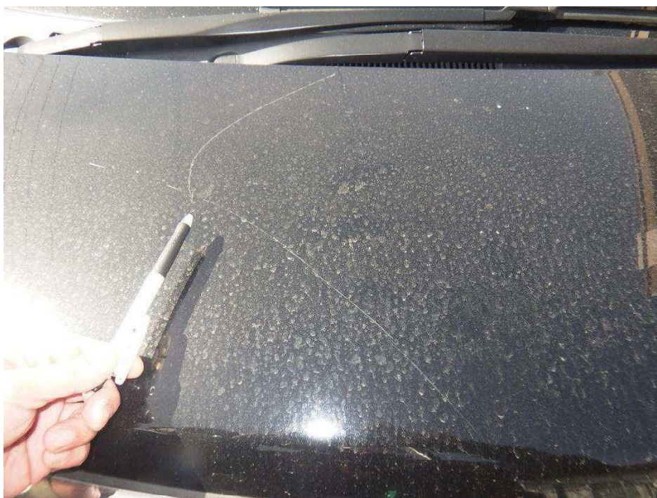
⑩ ボンネット右側付近②（右端から約60cmの位置から曲線状の傷及び 右端約40cmの位置の中央付近から前方部にかけて約60cmの傷）
