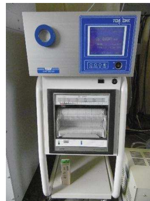
【図11】光化学オキシダント測定機 (高司中学校局)
