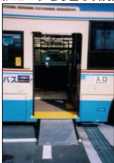
[ 乗車口 ] (スロープせり出し状況)
