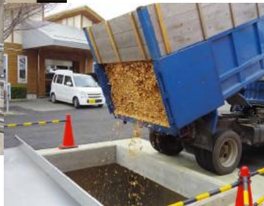
右：木質チップのボイラー燃料庫への受入
