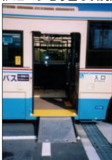
[ 乗車口 ] (スロープせり出し状況)
