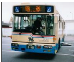
[ ニーリング状況 ]
