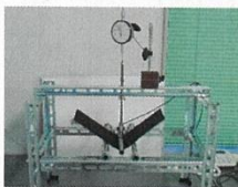
硬化後の曲げ試験状況（切片幅15cm、載荷重47N）
