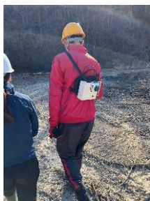
地上LiDARによる計測
