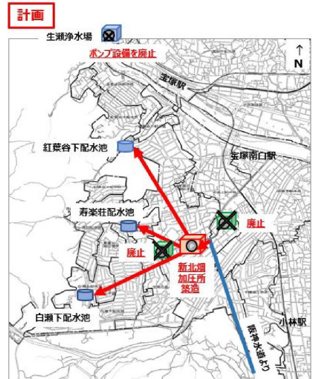
加圧所統廃合図（新北畑加圧所）
