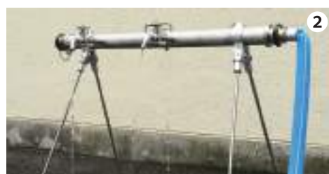
水道蛇口が付いた四脚をホースで繋ぎます
