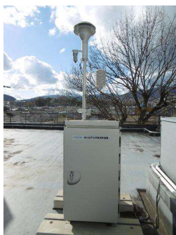
【図14】微小粒子状物質（PM2.5）測定機
