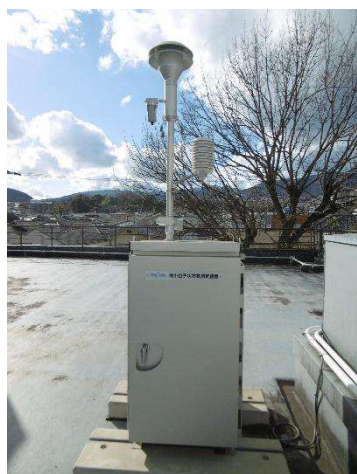
【図14】微小粒子状物質（PM2.5）測定機
