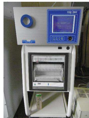
【図13】光化学オキシダント測定機 (高司中学校局)
