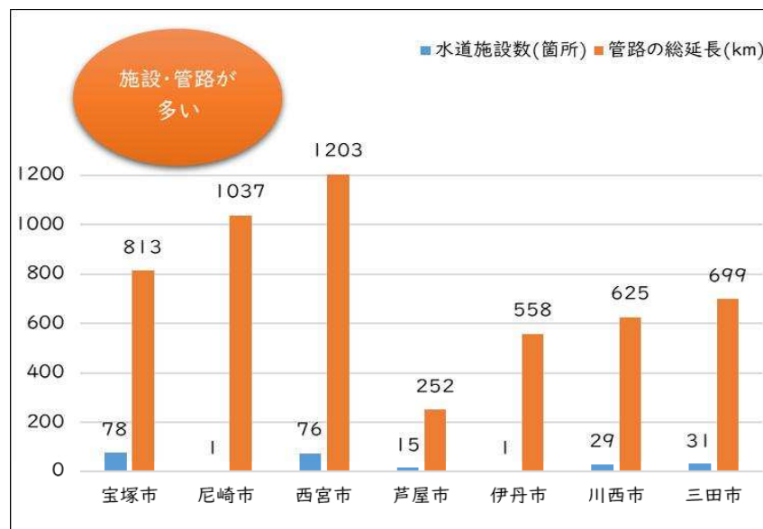
宝塚市と近隣市の水道施設箇所数(浄水場除く)
