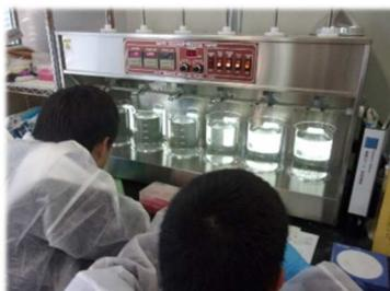
ジャーテスト（適切な薬品の量を調べる装置）
