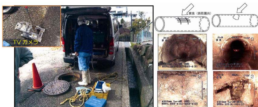
図 3-II-3 TVカメラ調査状況（左）、管内の劣化状況（右）
